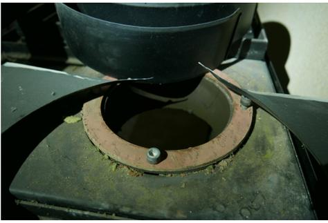
Stufa con guarnizione contenente amianto
