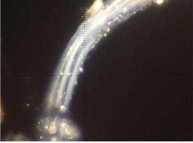
Tracce di amianto tra il massetto e la colla per moquette, verosimilmente cosparsi dopo la posa del massetto.
