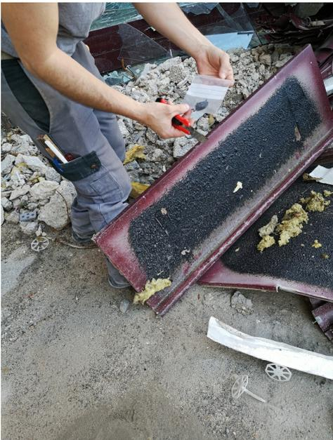
Fassaden-Platten mit asbesthaltiger bituminöser Beschichtung. Photo: C. Campoarmor, Arcadis Schweiz AG
